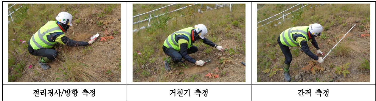
【그림 5.3.5】 불연속면 측정 현황
